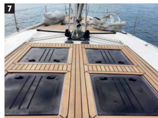
6. L'accesso alla cala dell'ancora non è dal ponte, ma dalla cala delle vele. 7. Il cielo della tuga si trasforma in prendisole ed è costellato di passauomo a filo. 8. Larghi passavanti consentono passaggi agevoli anche a barca sbandata.
