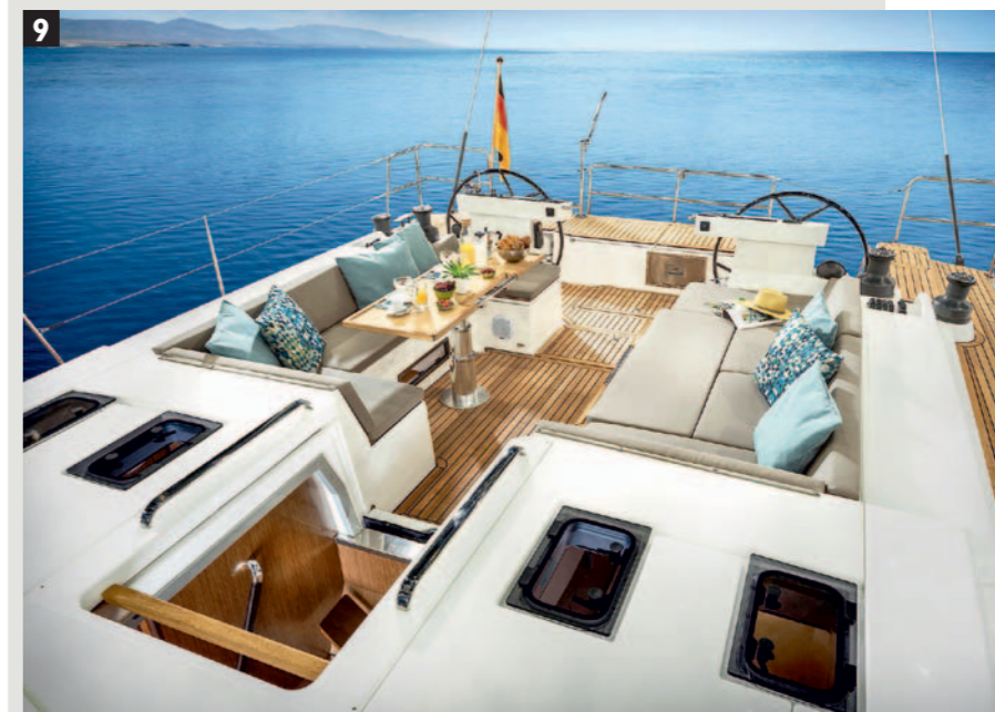
6. L'accesso alla cala dell'ancora non è dal ponte, ma dalla cala delle vele. 7. Il cielo della tuga si trasforma in prendisole ed è costellato di passauomo a filo. 8. Larghi passavanti consentono passaggi agevoli anche a barca sbandata.
